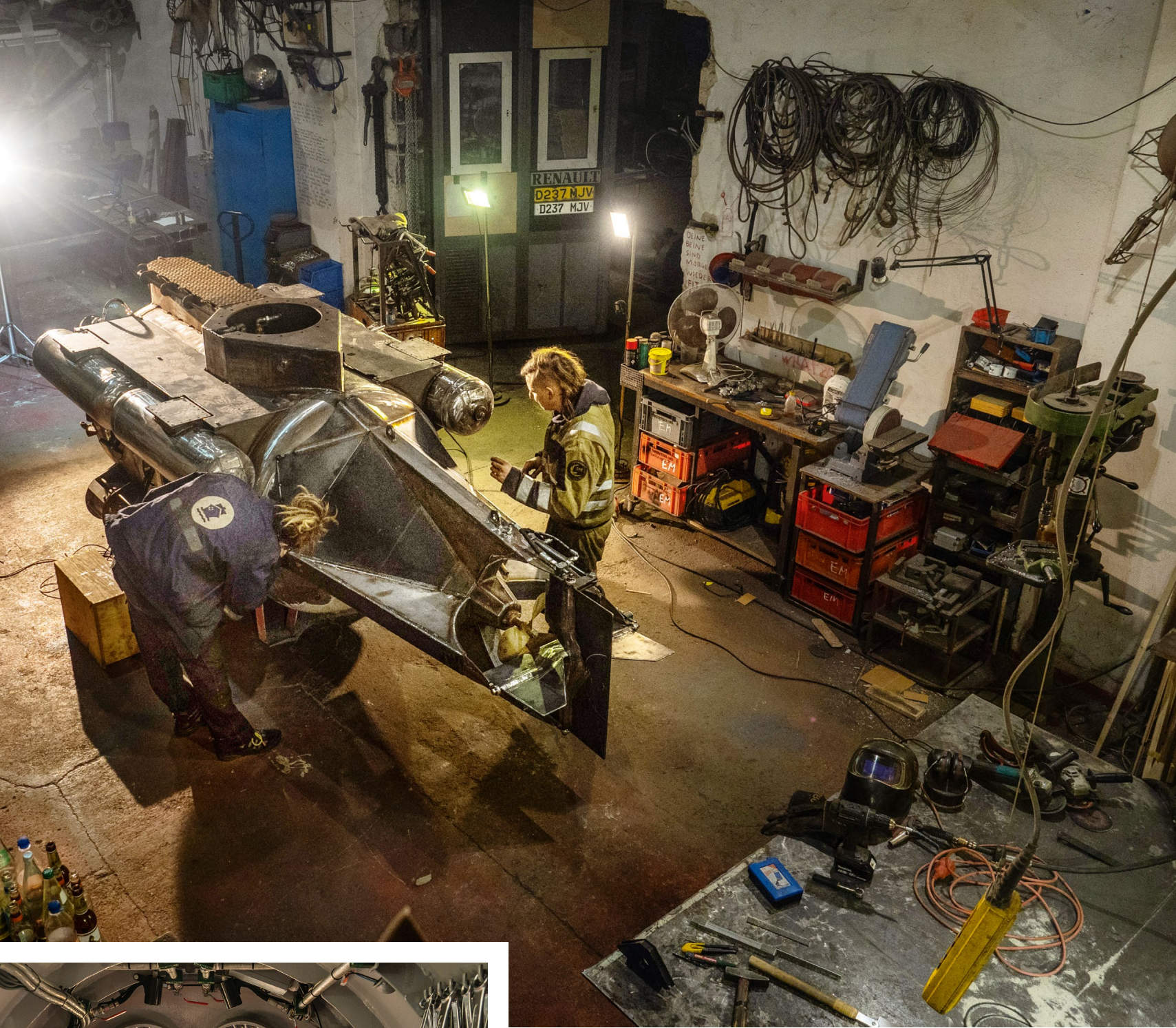
U-Boot in der Werkstatt, unlackiert, seitlich die Tauchtanks, hinten der Antrieb mit Propeller. Links: Elias Macke in seinem Arbeitsoverall mit Nasa-Aufnäher. Rechts: Das Cockpit, im Armaturenbrett ein alter russischer Kreiselkompass, ersteigert auf E-Bay
