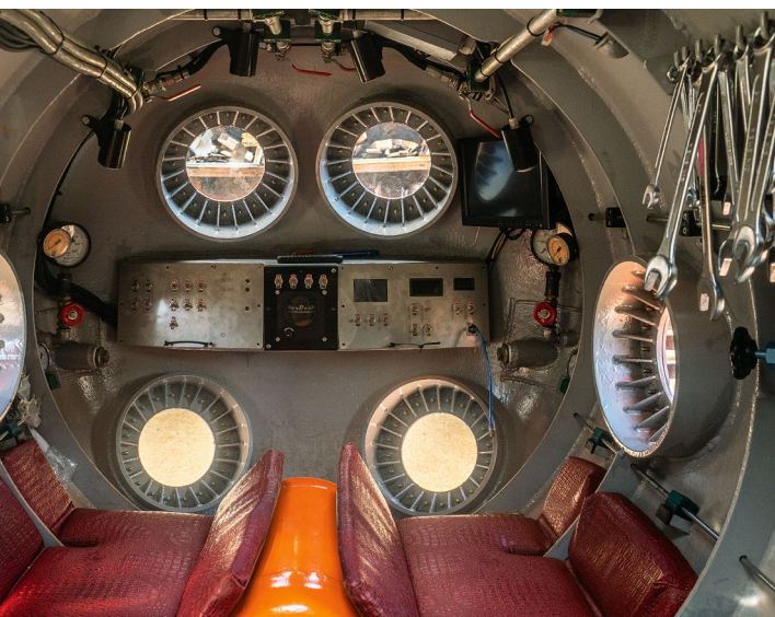
U-Boot in der Werkstatt, unlackiert, seitlich die Tauchtanks, hinten der Antrieb mit Propeller. Links: Elias Macke in seinem Arbeitsoverall mit Nasa-Aufnäher. Rechts: Das Cockpit, im Armaturenbrett ein alter russischer Kreiselkompass, ersteigert auf E-Bay
